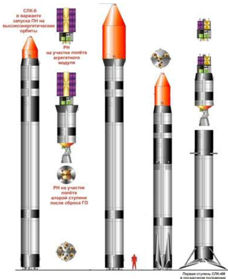
*Рис. 4. Проектный облик универсальной мобильной РН СЛК: базовый вариант СЛК-6 и вариант с укороченными топливными баками и спасаемой первой ступенью СЛК-4М*
